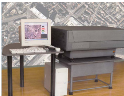
(Фиг. 27 Цветен фотограметричен скенер "Делта" – Украйна)
