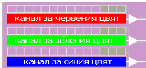
(Фиг. 28 Линеен CCD сензор на компанията KODAK).
